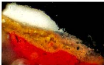
Mikroskopaufnahme, die einen Querschliff aus dem braunen Bildhintergrund zeigt. Auf der roten Grundierung sitzt die grünlich-bräunliche Malerschicht, die an der Kontaktfläche zum Vogelkot (weißer Patzen im Bild) glasiger wird und damit farblich verändert ist.
